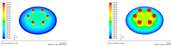
a) R_3=1.5\text{mm} 时轴承的压力分布云图 a) Pressure contour of bearing when R_3=1.5\text{mm}
